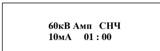
2.3.5.5 В режиме настройки параметров испытаний установите требуемое амплитудное значение напряжения испытаний **U исп**, и частоту.
