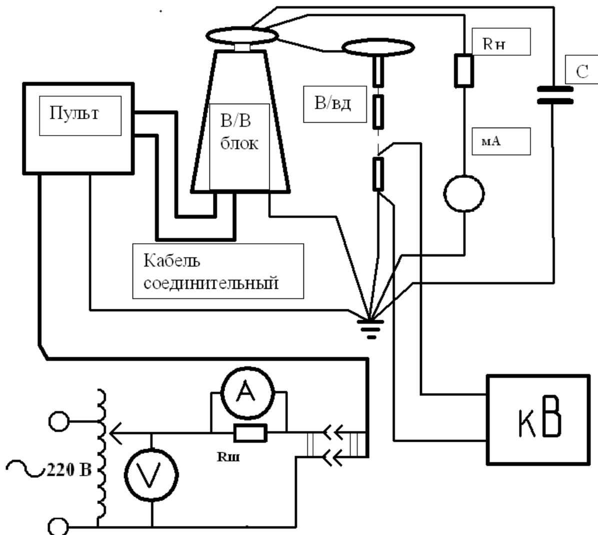
Пульт- пульт управления аппаратом; В/В блок- высоковольтный блок DC/ СНЧ60 кВ; V-цифровой мультиметр APPA205; A - амперметр Д5066 кл. т. 0,5;  $R_H$ -сопротивление нагрузки; В/вд- высоковольтный делитель ДН 100э; мА - вольтметр универсальный GDM 78255А, кл. т. 0.5; кВ - измеритель ИПН-2э;  $R_{ш}$  - шунт измерительный 75ШИС; А - цифровой мультиметр РС520, С- конденсатор высоковольтный 0,25мкФ,100кВ.
