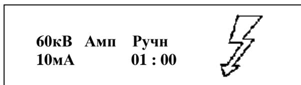
Аппарат начнет выдачу напряжения сверхнизкой частоты, амплитуда и частота которого выбраны в режиме настройки параметров испытаний.
