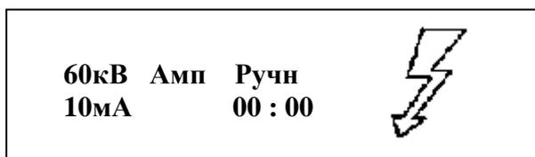
2.3.3.5 Плавно вращая ручку управления устанавливаем требуемое значение испытательного постоянного напряжения.
