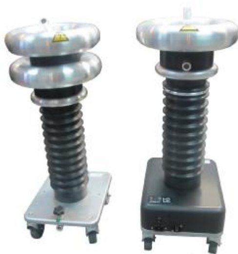
Рис. 2 Фильтр и конденсатор связи с детектором
