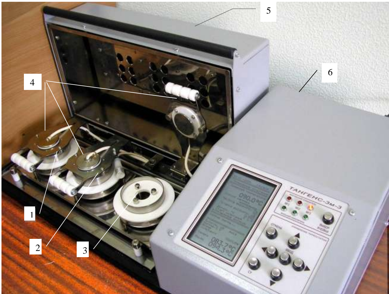
Рисунок 2. Блок основной «ТАН-БО». Внешний вид с открытой крышкой.
