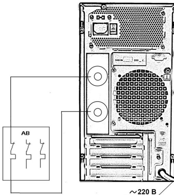
Рис.5. Схема подключения комплекта для проверки автоматических выключателей
