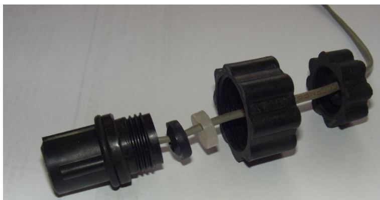
Рис. 1. Порядок сборки разъема телефонного аппарата.
