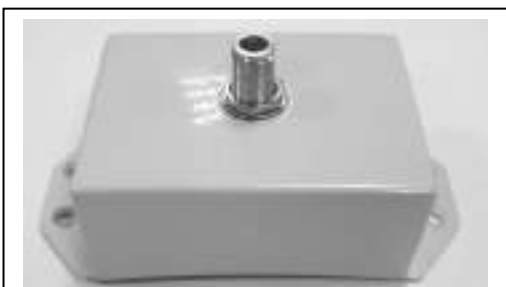
Рис. 2.4.1.1. Датчик марки «AES» для регистрации частичных разрядов в КРУЭ.
