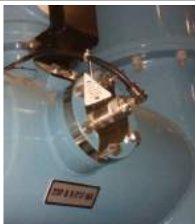
Рис. 2.4.2.2. Датчик «AES/W» на смотровом окне.
