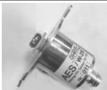
Рис. 2.4.2.1. Датчик марки «AES/W», измерительная часть.
